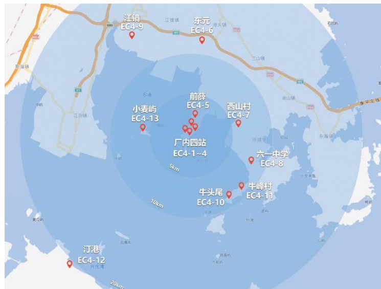
图1 环境 \gamma 辐射连续监测站方位示意图
